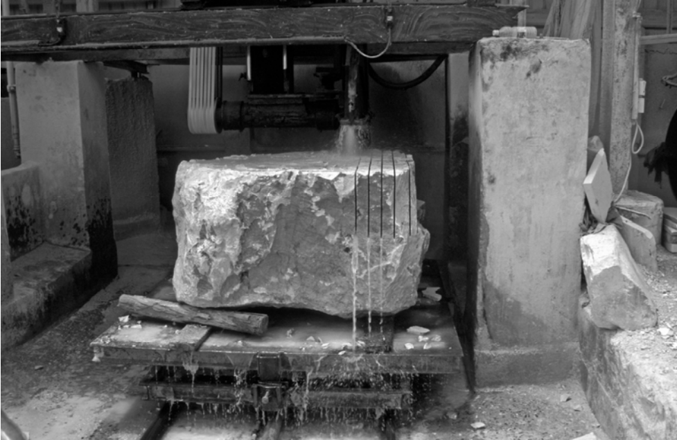
Abb. 7. Sägen eines Kalksteinblocks mit Hilfe einer zu kleinen Gesteinssäge.
