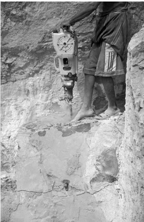
Abb. 5. Arbeiter (mit Sandalen) löst mit benzingetriebenen Bohrgerät einen Kalksteinblock aus dem Anstehenden.
